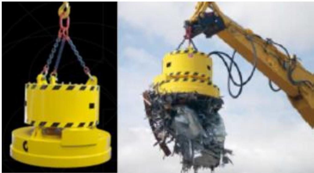
O eletroímã é completamente independente e, assim, pode ser utilizado em diversas máquinas. O eletroímã pode ser conectado à máquina, seja através de um gancho rápido (excluso do fornecimento), seja através de correntes e anel central. A função de magnetização e desmagnetização ocorre exclusivamente por meio do óleo hidráulico da máquina: não existem conexões elétricas. Basta apenas conectar as mangueiras de óleo da máquina onde será utilizado o eletroímã na entrada e na saída do gerador.
