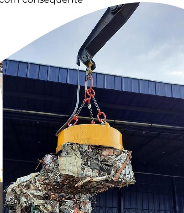
A carcaça dos eletroímãs é construída em aço de baixo carbono e alta permeabilidade magnética. Têm grande resistência ao impacto e ao desgaste. As laterais são aletadas, proporcionando melhor dissipação térmica. As sapatas polares são intercambiáveis, permitindo fácil substituição quando as mesmas são desgastadas pelo uso. Os interpolos são fundidos em aço manganês diamagnético com nervuras radiais, que conciliam alta resistência a impactos e baixo peso.
