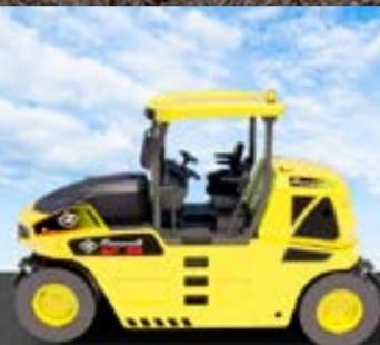
A utilização do rolo de pneus geralmente é combinada com a de outro compactador para dar acabamento na superfície. Seja rolo de patas estático ou vibratório no caso de solos, ou rolo liso, estático ou vibratório, no caso de revestimentos betuminosos. Configurado para trabalhar em faixas de até 2.095 mm, se torna o equipamento ideal tanto para obras em perímetros urbanos, como em rodovias.
